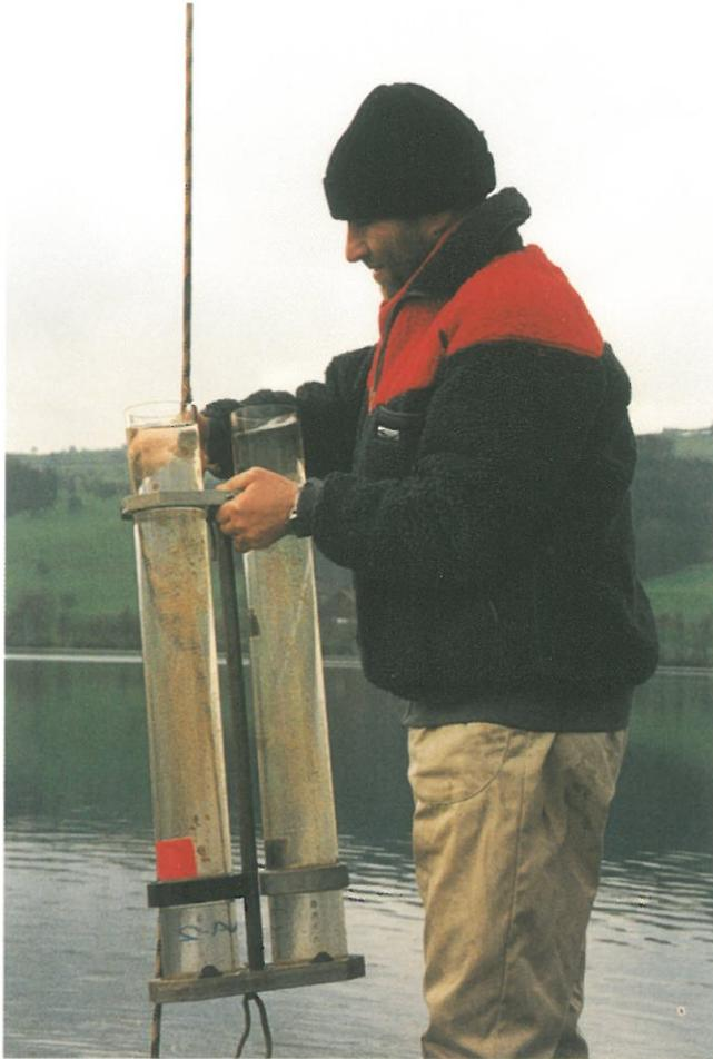
Fig. 49 Zylinderfalle aus Plexiglas mit auswechselbaren Probenbehältern. Mit einem Durchmesser von 10 cm und einer Gesamthöhe von 100 cm haben sie eine aktive Probenfläche von 65 cm<sup>2</sup> und eine aspect ratio von 1:10.
