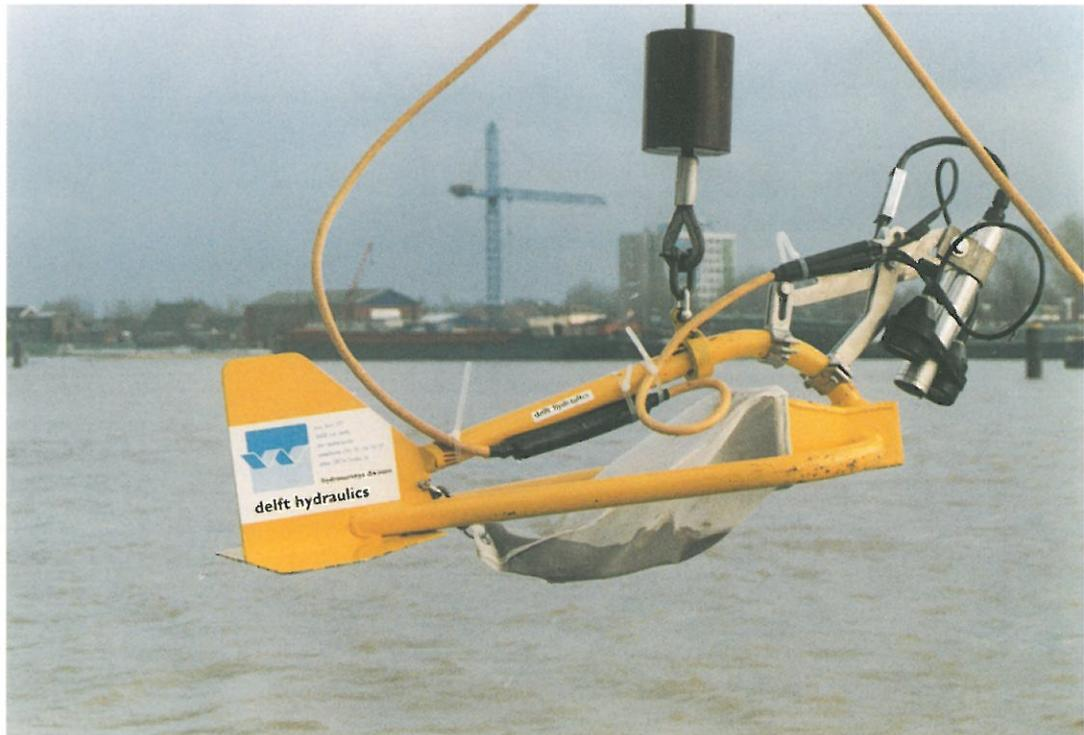
Fig. 42 Sedimenttransport-Probenahmegerät
