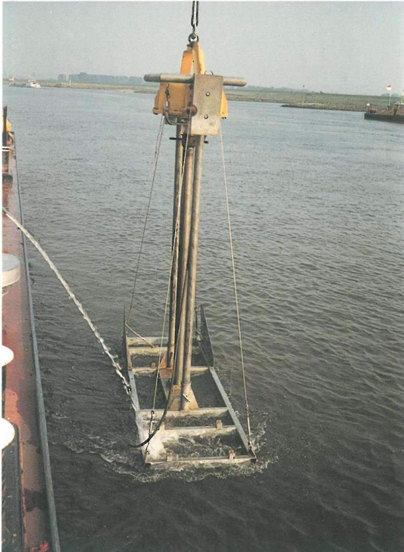
Fig. 56 Vibrocorer
