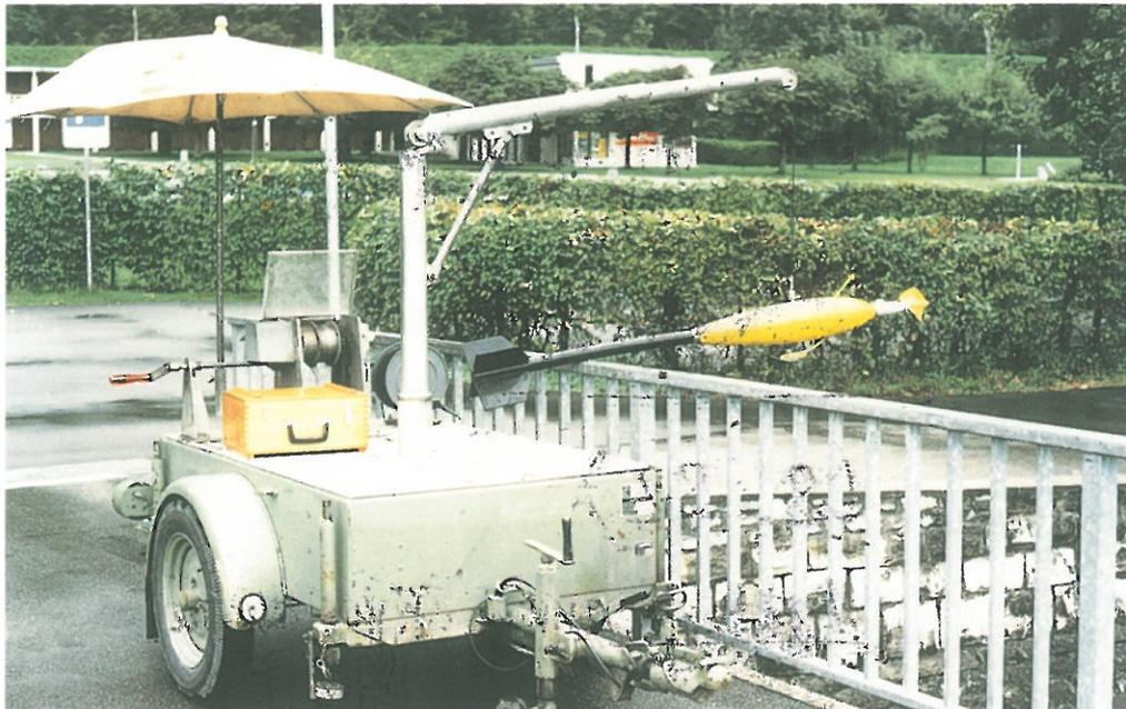
Fig. 9 Messwagen der LHG für die Messung von Schwebstoffkonzentrationen
