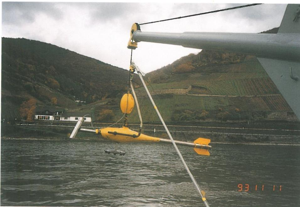
Fig. 37 Trübungsmessgerät mit Halterung am Ott-Mittelstück
